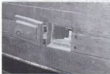
Abb. 5: Eine Lüftungspforte des ENDEAVOUR Nachbaus. Photo B. Haddock
