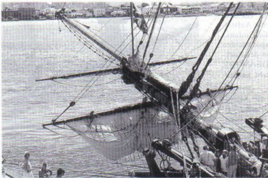
Abb. 14: Das Vorgeschirr des Nachbaus. Die Flämischen Pferde gehören nicht an die Blinde-Rah!
