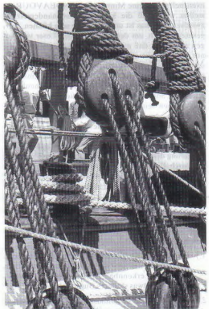
Abb. 15: Die Juffernzurring im Fockwant. Bei der mittleren ist zu erkennen, daß keine Augbändselung vorhanden ist.
