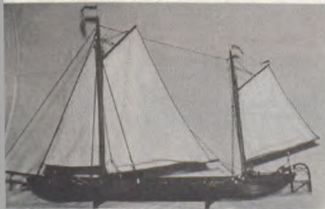
Abb. 8 Ruhraak, oftener Kohlenkahn von der Ruhr, bis zum 19. Jahrhundert; M 1:30 (1956)
