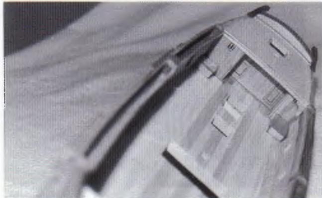
Abb. 11: Ein Gleiches geschah im Achterschiff. Über die gesetzten Kammerwände wurden die Decksbalken verlegt, dann erfolgte die Beplankung der Poop. Vor den Kammern befinden sich auf dem Oberdeck Flaggenkästen. Alles später nicht mehr Erreichbare wird gleich lackiert. Desweiteren erkennt man auf dem Foto auch bereits die Schandeckel mit den aufgesetzten Hängemattenkästen.
