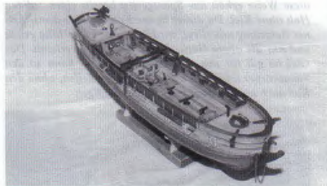
Abb. 13: Im nächsten Arbeitsschritt wurden alle notwendigen Aufbaudetails gefertigt und angebracht, die Stückpfortendeckel eingesetzt und, wo nötig, farbliche Akzente gesetzt und das Deck mit Klarlack vor Verschmutzung bewahrt.
