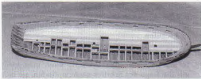
Abb. 9: Der so gefertigte Rumpf, hier von der Helling genommen, erhält die Innenbeplankung, die Spantköpfe werden auf entsprechende Länge geschnitten, die Mastspuren vorsorglich auf das Kielschwein geleimt und die Decksbalken gesetzt. Nachdem die Wassergänge gelegt sind, wird von der Mitte her das Dach beplankt.
