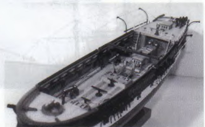
Abb. 14: Schritt für Schritt geht es vorwärts. Der Rumpf erhielt seinen Anstrich, Juffern sitzen in den Rüsten, die Reservehölzer und die bronzenen Geschütze wurden entsprechend den Angaben an Deck untergebracht. BEAGLE führte Geschütze aus Bronze, um nicht durch das Eisen herkömmlicher Geschütze die Kompassse zu beeinflussen. Auf beiden Seiten der Poop sind nun die Davits der außenbords hängenden Boote befestigt.
