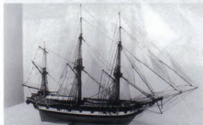
Abb. 21: Dieses Bild zeigt das Schiff mit gesetzten Schratse-geln, also allen Segeln, die in der Längsrichtung des Schiffes stehen. Die Menge des Tauwerks häuft sich, und es wird zu-nehmend schwieriger, alle Leinen richtig laufen zu lassen.
